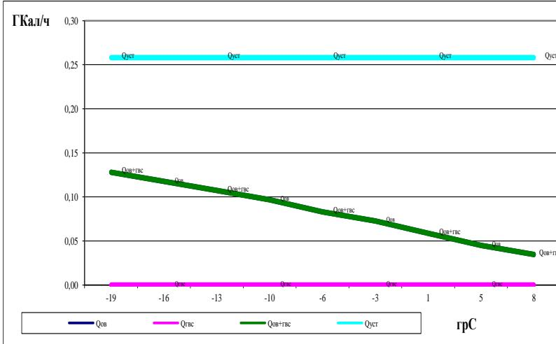
Теплопроизводительность котельной превышает необходимую на 0,13 Гкал/ч на существующее положение. Резерв тепловой мощности существующей котельной по существующим нагрузкам составляет 0,13 Гкал/час.
