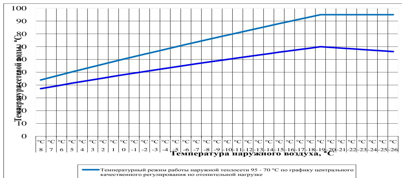
**Расчётный температурный график системы отопления, 95 - 70 °C**
