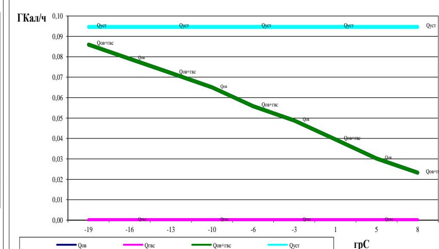
Теплопроизводительность котельной превышает необходимую на 0,08 Гкал/ч на существующее положение. Резерв тепловой мощности существующей котельной по существующим перспективным нагрузкам составляет 0,08 Гкал/час.
