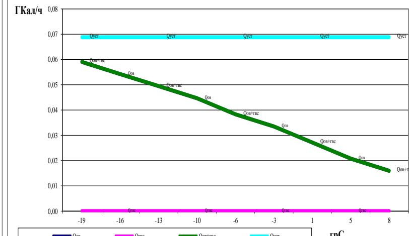
Теплопроизводительность котельной превышает необходимую на 0,2 Гкал/ч на существующее положение. Резерв тепловой мощности существующей котельной по сущ.и перспективным нагрузкам составляет 0,2 Гкал/час.
