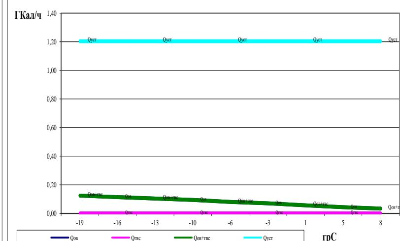
Теплопроизводительность котельной превышает необходимую на 0,19 Гкал/ч на существующее положение. Резерв тепловой мощности существующей котельной по существующим нагрузкам составляет 0,19 Гкал/час.
